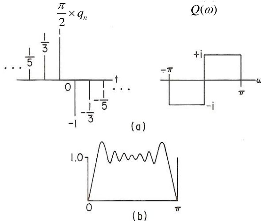
(a) El operador discreto ideal y su espectro. (b) El espectro de amplitud del operador truncado. Su espectro de fase es exacto.
